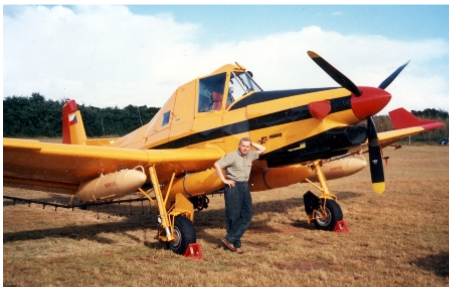
Agro Turbo s podvěšenými čtyřmi baky paliva - v této verzi vezlo celkem 750 litrů leteckého petroleje
